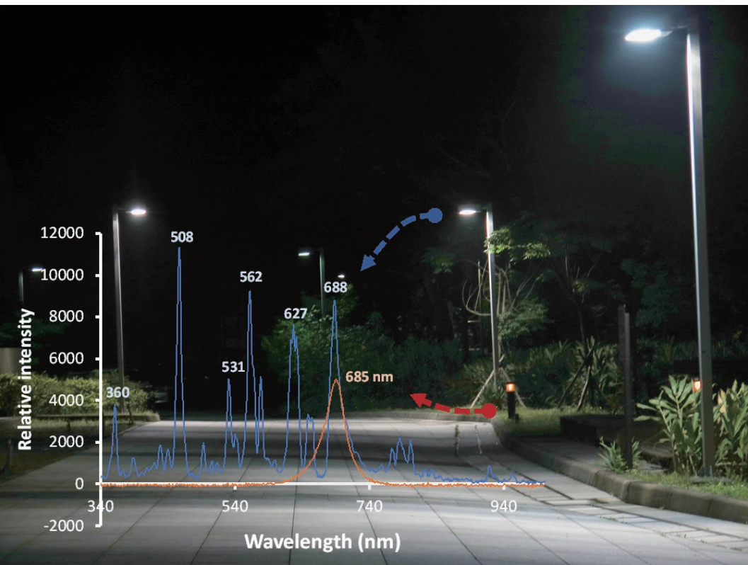
圖九、中央研究院跨領域大樓旁的路燈光譜。低矮的紅光路燈避開了螢火蟲等昆蟲的光敏感波長區。（王子元 攝製）
